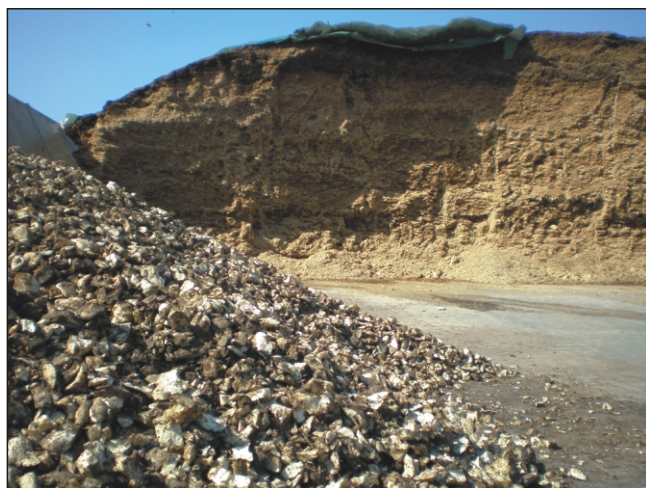
Fot 2. Surowiec do produkcji biogazu - rozdrobnione buraki i kiszonka z kukurydzy, żyta i słonecznika
