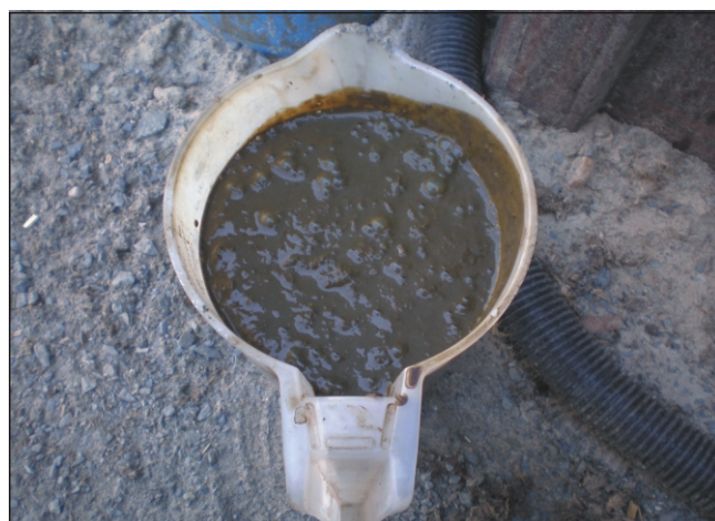
Fot 3. Zawartość zbiorników fermentacyjnych, widoczne bąbelki gazu
